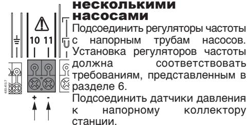
Для лучшей работы станции рекомендуется установить датчики давления в одной точке с коллектором и установить манометр для визуализации давления.
