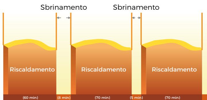
Se la temperatura esterna rigida provoca la formazione di ghiaccio sulla batteria condensante, il corretto funzionamento del climatizzatore in caldo richiede che ci sia uno stop di immissione aria calda in ambiente per consentire lo sbrinamento dello scambiatore esterno. Nel caso specifico, questi stop non sono programmati ad intervalli regolari, ma hanno luogo solo se e quando veramente necessari, garantendo continuità di afflusso di aria calda in ambiente.
