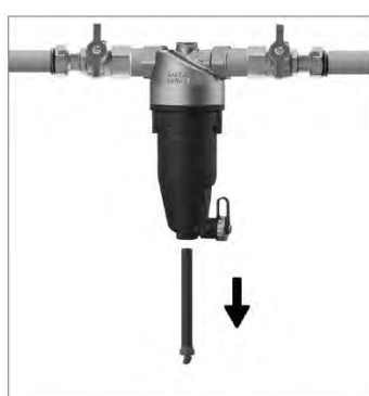
2. Rimozione del magnete.
