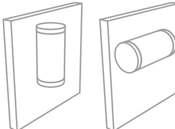
Con il kit di fissaggio a parete (opzionale) è possibile l'installazione a parete in verticale o in orizzontale.
