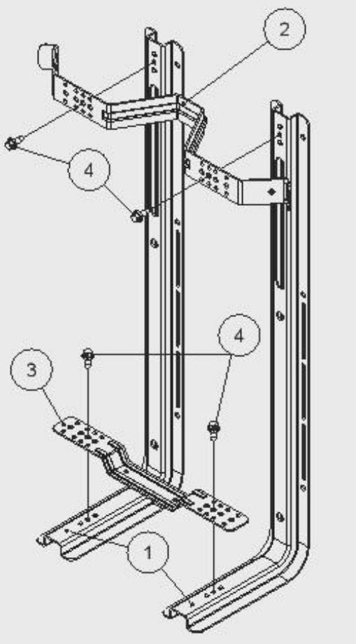
Unico supporto universale sul quale si montano tutti i sanitari sospesi WC e BIDET con i seguenti interassi: 160 - 180 - 200 - 230 mm.
