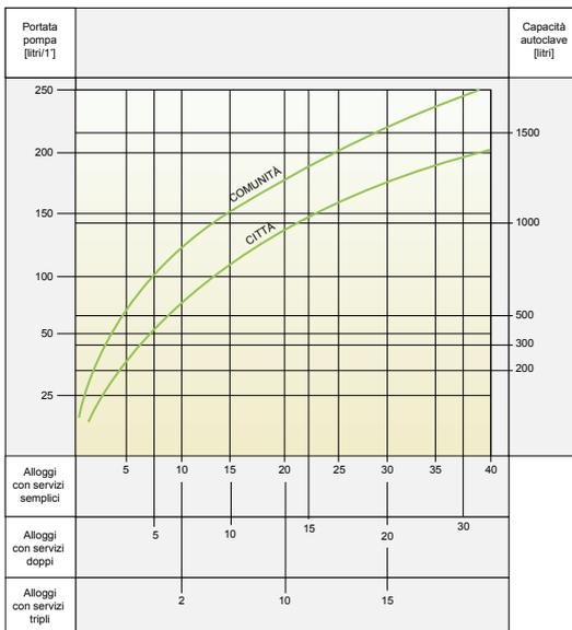
Per la determinazione rapida della capacità dell'autoclave e della portata delle pompe in funzione del numero degli appartamenti si può utilizzare il seguente diagramma (valido sempre per circa 15 avviamenti orari):
