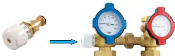
Il by-pass differenziale regolabile, se necessario, deve essere montato sul ritorno e permette di far bypassare il fluido quando l'impianto a monte è chiuso o parzialmente chiuso. È possibile impostare pressioni di apertura fra 50 e 400 mbar come mostrato nel grafico (fig. C).
