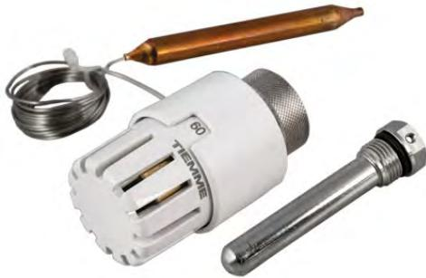
La testa termostatica con sonda serve a regolare l'apertura della valvola miscelatrice. È possibile impostare una temperatura tra 20 e 50°C. Una volta impostata la temperatura, questa viene controllata dalla sonda posta sulla mandata e mantenuta nel tempo. Il kit è fornito di un pozzetto portasonda e di un nipplo che serve per il fissaggio della sonda all'interno del foro.
