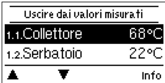
Visualizzazione delle temperature misurate correnti.
