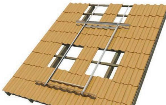
Posizionare prima quella di sinistra, sollevando le rondelle di fissaggio superiore e inferiore (9) del collettore. Quando il collettore viene posizionato sotto, si serrano leggermente le viti e i dadi M8 con le rondelle di fissaggio (9) del collettore al fine di montarlo temporaneamente e centrarlo facilmente con il sistema. Posizionare i raccordi Ø22 serrati meccanicamente ai bordi del collettore.
