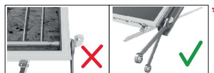
Unire l'altra estremità alla presa sinistra superiore del collettore utilizzando il blocco d'angolo  $\varnothing 22 \times \text{DN}16$  INOX\* avendo prima fatto passare il tubo attraverso il tubo di isolamento.
