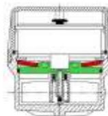
L'aumento di volume dell'acqua viene ammortizzato dalla molla Bauer che riporterà a condizioni normali la piastra di tenuta del contatore dopo il disgelo, mantenendone inalterate le caratteristiche di precisione.
