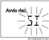
Se viene rilevato un modulo solare, il display passa alla configurazione dell'impianto solare.
