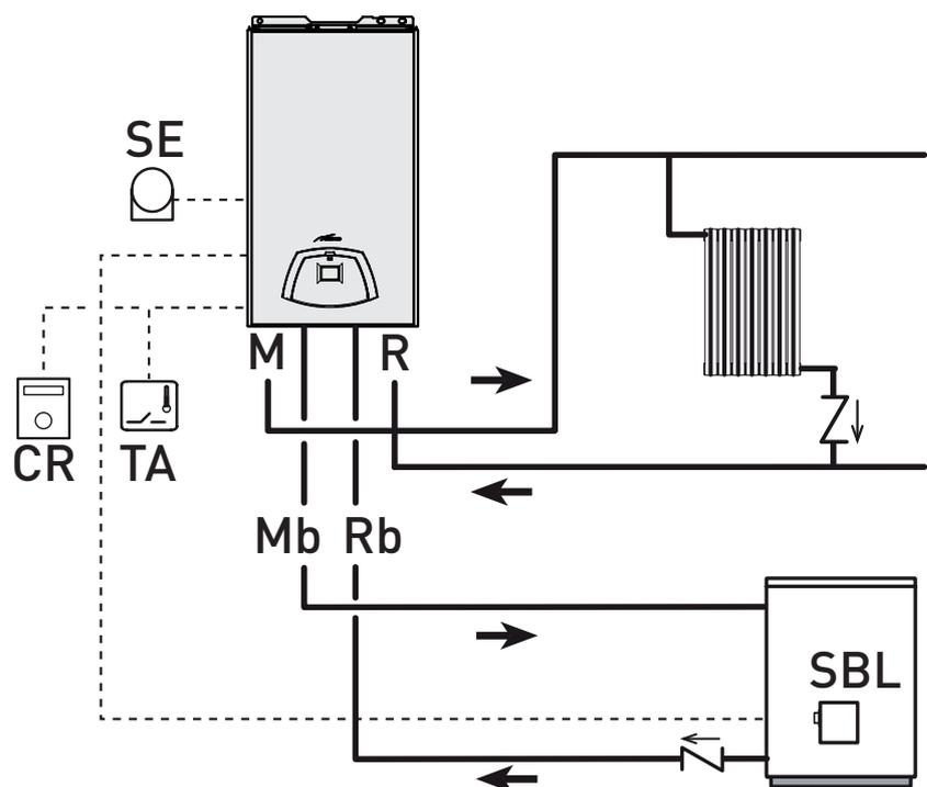
Caldaie murali a condensazione di ultima generazione per il riscaldamento e per la produzione di acqua sanitaria istantanea quando sono abbinata ad un bollitore ad accumulo.
